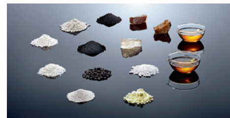
Die verschiedenen Inhaltsstoffe eines Reifens.
