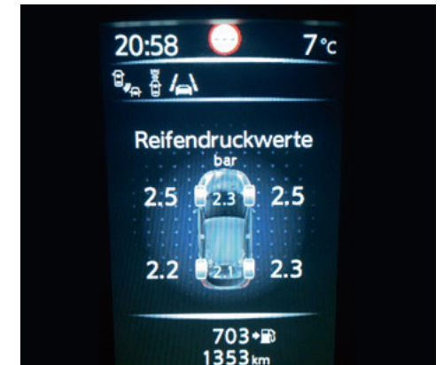
Beispielanzeige eines direkt messenden Systems.
